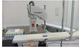
三菱電機 ロボット RH-6SDH + 三菱電機 二次元ビジョンセンサ
